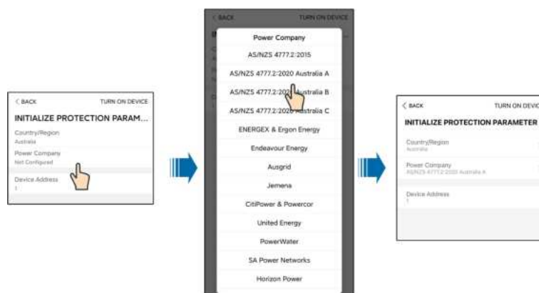
Figura 7-4 Empresa de energia elétrica de inicialização
